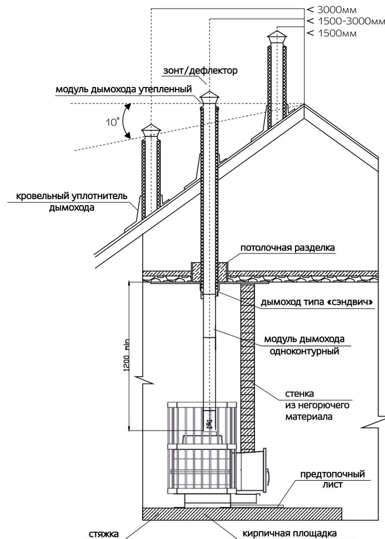
Рис. 3. Схема установки печи Kennet Атлант 22П сетка, ковка, панорама, вид сбоку
